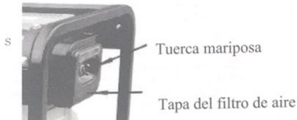
No utilice detergente para lavar el elemento del filtro de aire. Cuando el rendimiento del motor disminuye o cuando el color de los gases de escape no es normal, cambie el elemento del filtro. Nunca ponga en marcha el motor sin el filtro de aire ya que objetos extraños pueden entrar en la toma y dañar el motor.
